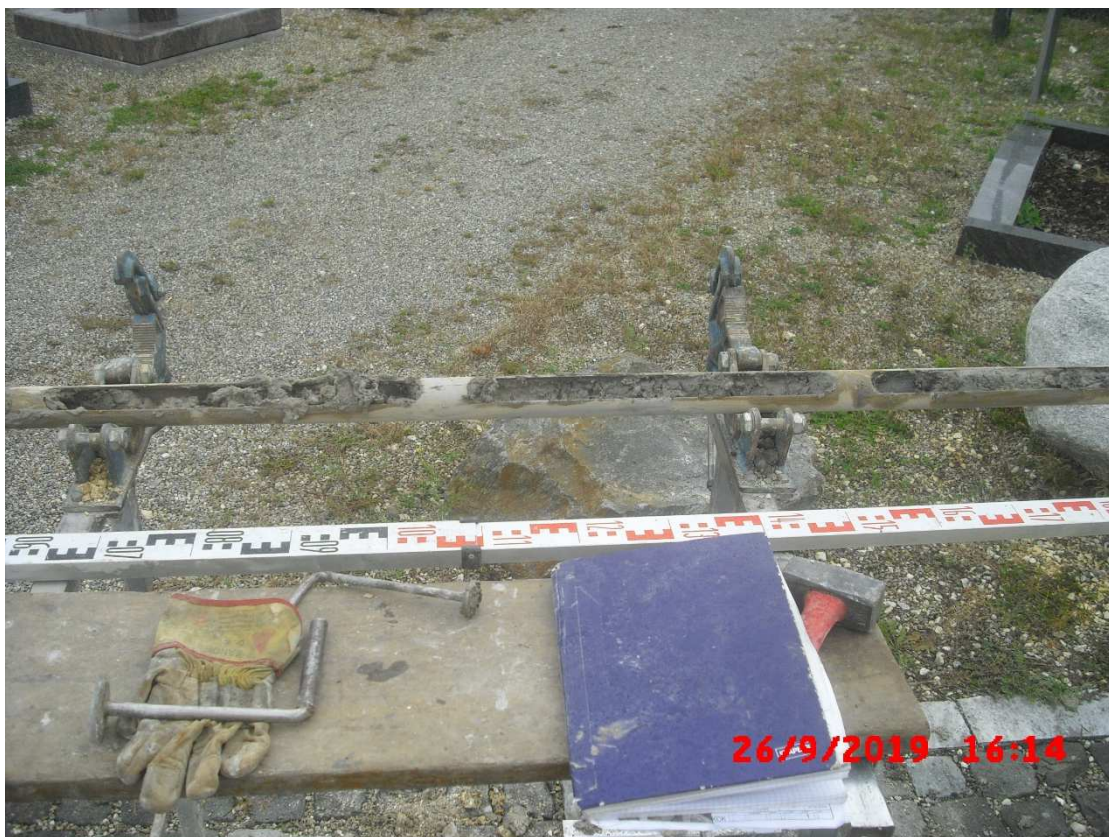
Abb. 8: Bohrkern KRB3, 3,5-6,3 m
