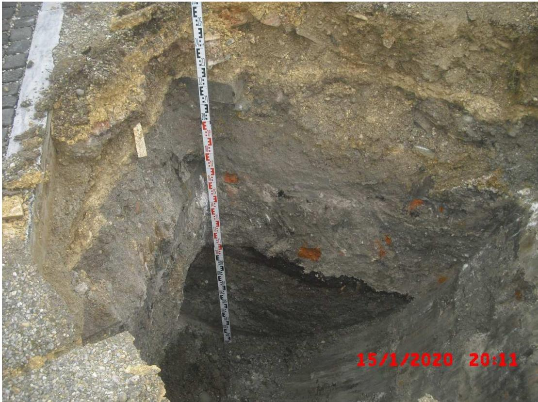
Abb. 1: Schurf S8, westliche Schurfwandung. In 1,6 m Tiefe befindet sich eine ca. 10 cm starke Lage aus teerhaltigem Material (Straßenabruch, Fräsgut o.ä.).
