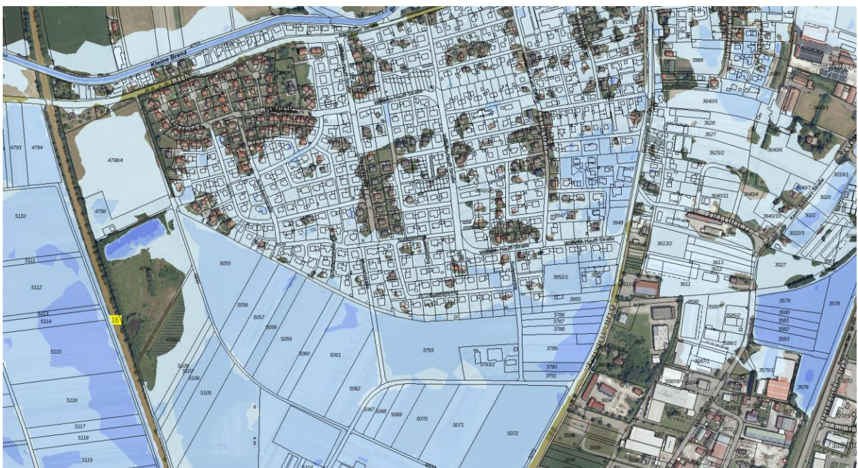
Abb. 9: Wassertiefen des HQ_{\text{extrem}} im Umfeld des Plangebietes, o. M. (© 2020 Bayerische Vermessungsverwaltung)
