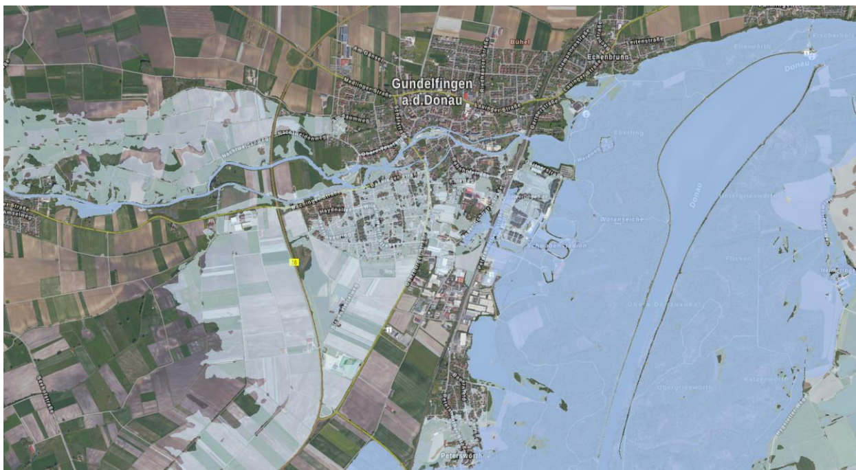
Abb. 10: Überlagerung von HQextrem (hellblau) und HQ100 (dunkel blau) o. M. (© 2020 Bayerische Vermessungsverwaltung)
