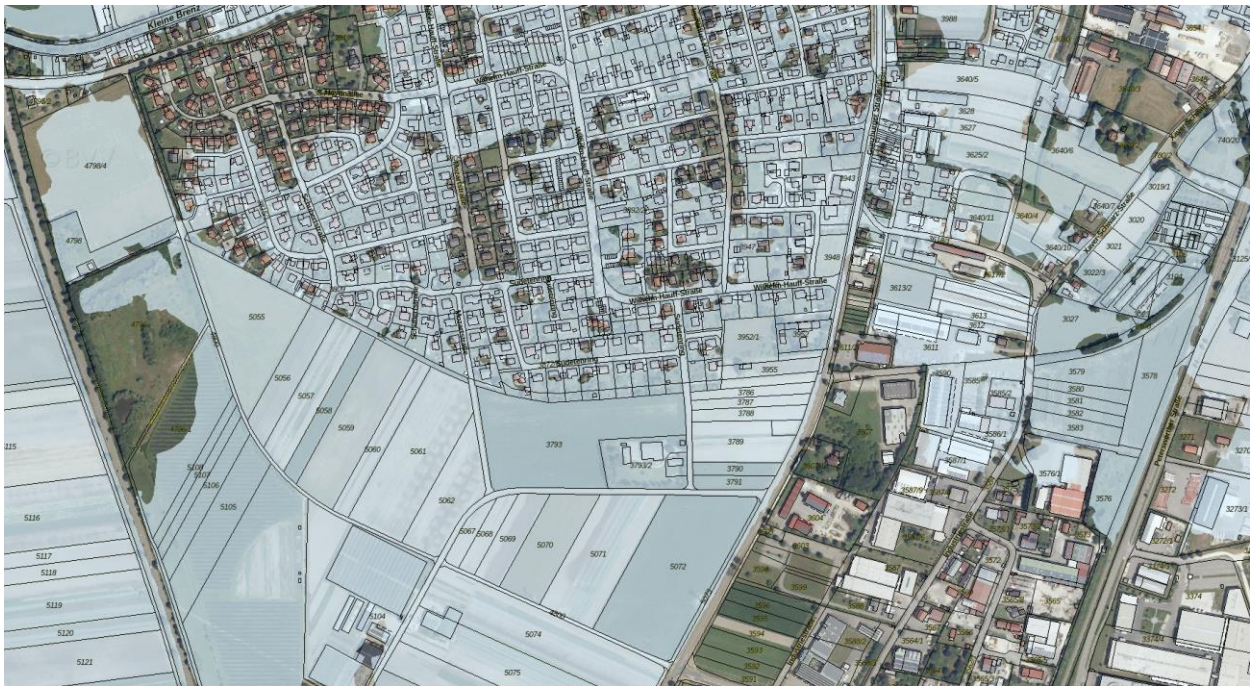
Abb. 8: Ausdehnung des HQ_{\text{extrem}} im Umfeld des Plangebietes, o. M. (© 2020 Bayerische Vermessungsverwaltung)
