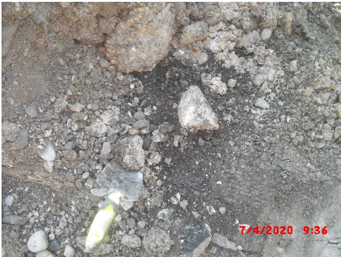
Abb. 4 : Detailansicht der teerhaltigen Lage aus Abb. 3 .
